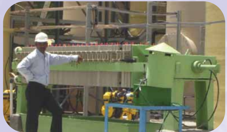
印度 Sterlite 光纤厂 压滤机过滤带有 SiO_2 微粒的盐酸
